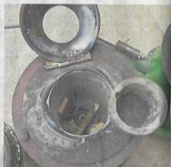
Ein Schmelzofen, um das Rohmaterial zu verflüssigen.
